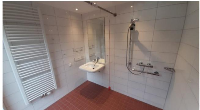
An mehreren Stellen im Bad werden Haltegriffe angebracht. Außerdem befinden sich an zwei Seiten des Bades Notrufklingeln. Im Bereich der Toilette sind zusätzliche Warm- und Kaltwasseranschlüsse sowie Stromanschlüsse vorinstalliert, so dass auf besonderen Wunsch die Nutzung eines Dusch-WC-Aufsatzes zur Intimhygiene optional möglich ist. Zur Ablage der Waschutensilien gibt es einen eingebauten Schrank über der Toilette sowie installierte Körbe neben dem Waschbecken.
